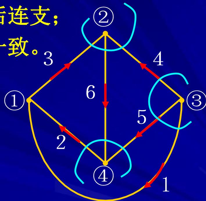
$$[Q_f] = \begin{matrix} & \begin{matrix} \text{支} \\ \text{割集} \end{matrix} & \begin{matrix} 1 & 2 & 3 & 4 & 5 & 6 \end{matrix} \\ \begin{matrix} Q_1 \\ Q_2 \\ Q_3 \end{matrix} & \begin{pmatrix} 1 & 0 & 0 & 1 & 1 & 0 \\ 0 & 1 & 0 & 0 & -1 & -1 \\ 0 & 0 & 1 & 1 & 0 & -1 \end{pmatrix} \\ & \underbrace{\hspace{10em}}_{Q_t} & \underbrace{\hspace{10em}}_{Q_l} \end{matrix} \\ = [1 \quad Q_l]$$
