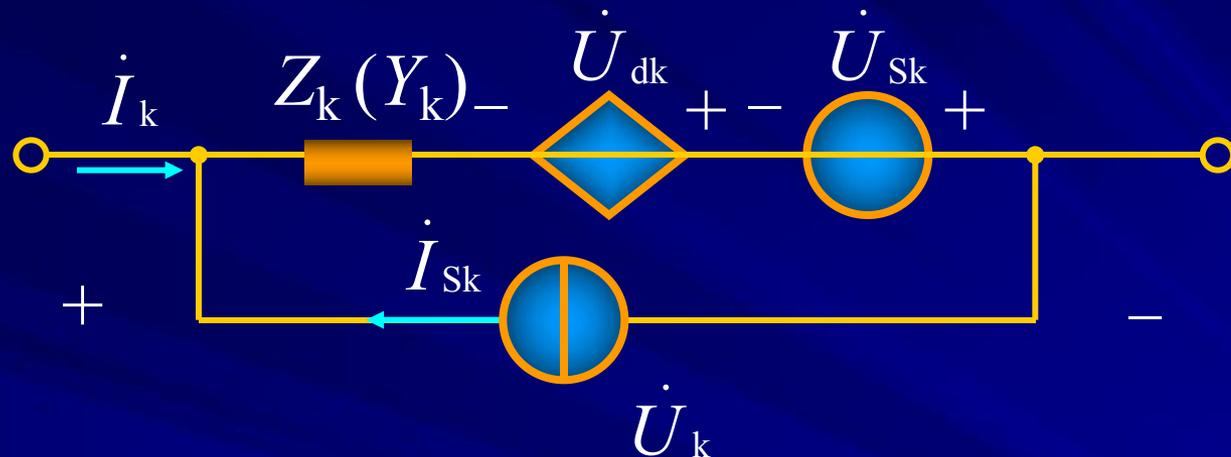
[Z]的非主对角元素将有与受控电压源的控制系数有关的元素。
