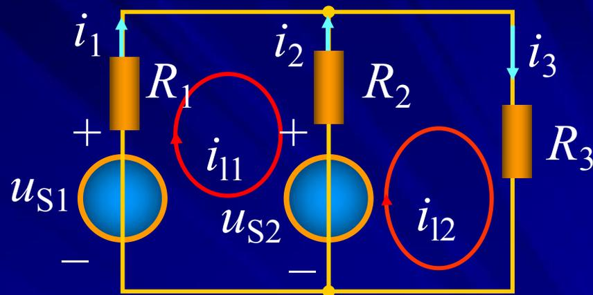
$u_{S11} = u_{S1} - u_{S2}$  网孔1中所有电压源电压的代数和。
