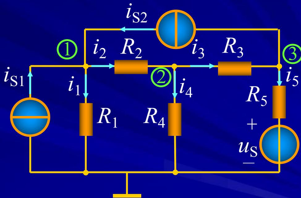
$$\begin{cases} i_1 + i_2 = i_{S1} + i_{S2} \\ -i_2 + i_4 + i_3 = 0 \\ -i_3 + i_5 = -i_{S2} \end{cases}$$
