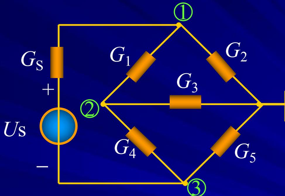
$$\begin{cases} (G_1 + G_2 + G_s)U_1 - G_1U_2 - G_sU_3 = G_sU_s \\ -G_1U_1 + (G_1 + G_3 + G_4)U_2 - G_4U_3 = 0 \\ -G_sU_1 - G_4U_2 + (G_4 + G_5 + G_s)U_3 = -G_sU_s \end{cases}$$
