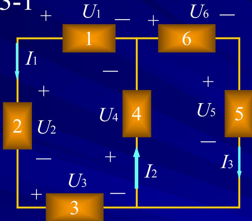
求图示电路中各方框所代表的元件吸收或发出的功率。
