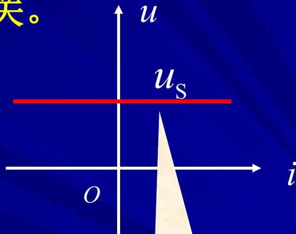
直流电压源的伏安特性曲线
