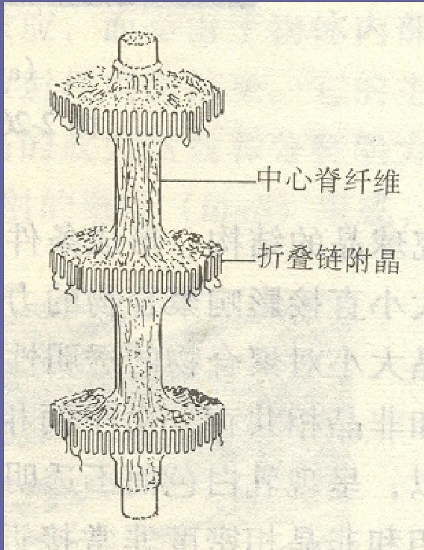
串晶结构示意图
